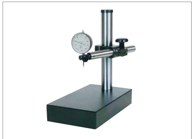
\* Die Meßuhraufnahmen sind auswechselbar. Es sind zusätzliche Meßuhraufnahmen mit Aufnahmebohrung 10H7, sowie Adapter für gängige elektronische Längenmeßtaster verfügbar.
